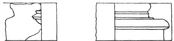
7. kép. Az egyhajós templom déli falában feltárt (in situ) nyugati karzat lábázatának felmérési rajza Dessin de métrage du soubassement de la tribune occidentale mis a jour (in situ) dans le mur méridional de l'église a une seule nef
