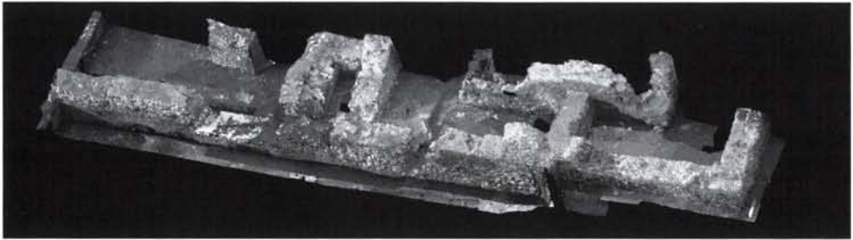
10. kép: Római épületfalak lézerszkenneres felmérése Fig. 10: Laserscanned pointcloud of the Roman walls
