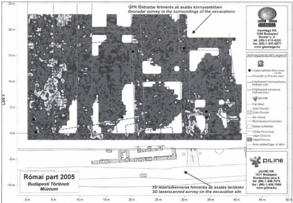
11. kép: Összesített alaprajz a geofizikai felmérés és a feltárt terület lézerszkenneres felvétele alapján Fig. 11: Ground plan based on the result of the geophysical survey and laserscanned remains
