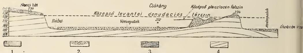
Fig. 3 Profil durch den Abschnitt der Rába in der Gegend Ivánc und Nagycsákány. 1. Lehm mit Bohrz (Löss); 2. mittelpleistocäner Schotter (z. T. unter dem heutigen Inundationsgebiet); 3. oberlevantinische Schotterdecke; 4. Pontikum. Középső pleisztocén felszín = Mittelpleistocäne Oberfläche; középső levantei denudációs tórstin = Mittellevantinische Denudationsfläche.
