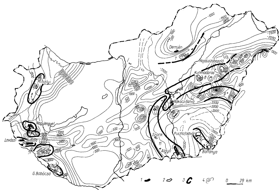
2. ábra. Magyarország kőolaj- és földgázelfordulásainak regionális övei. Jelmagyarázat: 1. Kőolaj-elfordulás, 2. Földgázelfordulás, 3. Kőolaj- és földgázelfordulások regionális övei (1. Mihályi—Répcelak—Ikervár—Ölbő, 2. Barabásszeg—Nagylengyel—Bak, 3. Zalatárnok—Pusztaderics—Hahót—Pusztaszentlászló—Kilimán, 4. Lovászi—Újfalu—Budafa, 5. Belezna—Bajcsa—Inke—Vése, 6. Vizvár—Heresznye—Babócsa, 7. Bükkszék—Fedémes—Demjén—Mezőkeresztes, 8. Jászkarajenő—Hajdúszoboszló, 9. Túrkeve—Biharnagybajom—Körösszegapáti, 10. Battonya—Tótkomlós—Pusztaszőlős—Pusztaföldvár, 11. Algyő—Deszk—Szolnok—Törtel—Nagykörös—Szank—Üllés—Dorozsma), 4. Harmadidőszaki medencealjzat szintvonalai
