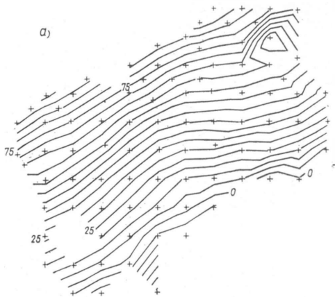
3. ábra. Graphomattal rajzolt térkép. a) fekvőszintvonalak Abb. 3. Durch Graphomat hergestellte Karte. a) Isophyten des Ljegendes
