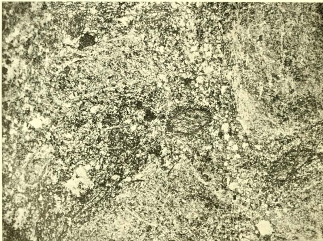
14. ábra. Diorit-porfirít 25 2 -szeres nagyításban Felsőbenkovácról. Plagioklász és amfibol a plagioklászából, amfibolból, kloritból és magnetitből álló alapanyagban nagyobb zárványokat képeznek.
