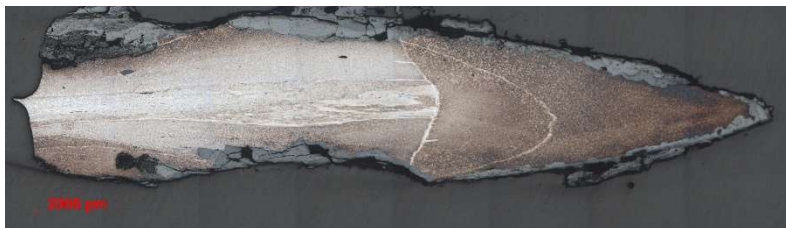
2. ábra: A pengéből kimetszett minta mozaikfelvétele. A felvétel bal oldalán a penge magja, jobb oldalán pedig a penge éle látható.
