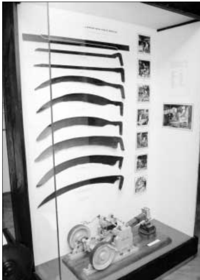
A kaszagyártás néhány művelete és a „farkas kalapács” makettje
