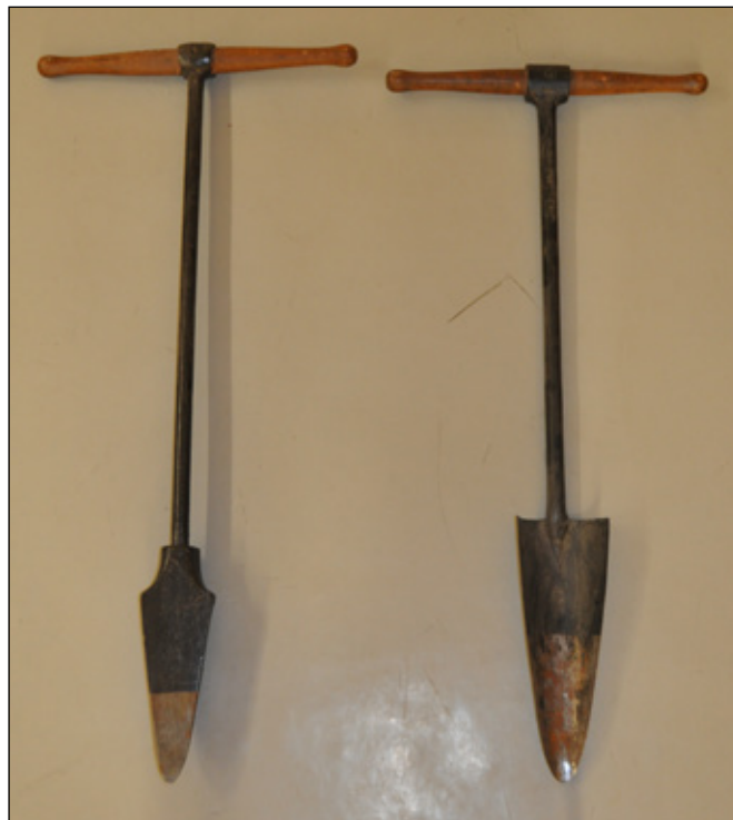
6. kép. Wartenberg-féle ültetővas (bal) és homorásó (jobb)
