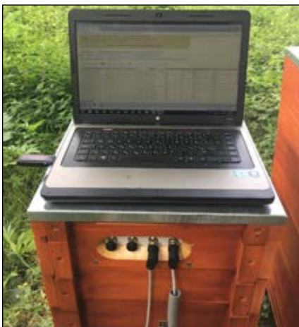
2. kép. A GreenBee projekt keretében fejlesztett okoskaptár
