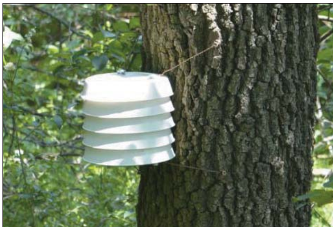
3. ábra. A fa törzsére kihelyezett árnyaló (Fotó: Stofa Krisztián)
