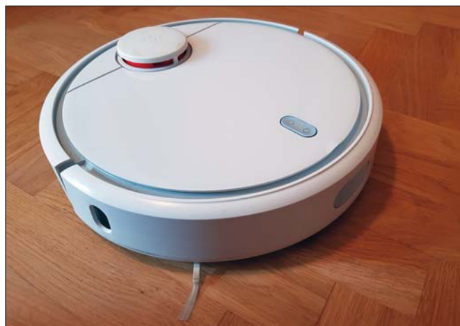
3. kép. Robotporszívó lidar egységgel – Fotó: Kovács F.
