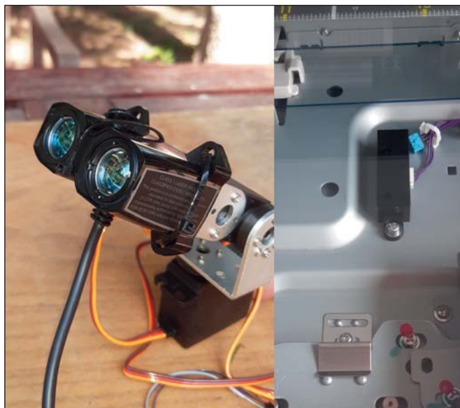
1. kép. Szenzorok: lézertáv-mérő (bal), irodai nyomtatóban, mint lapérzékelő (jobb)
