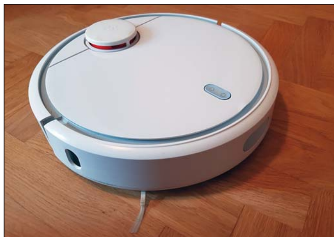
3. kép. Robotporszívó lidar egységgel – Fotó: Kovács F.
