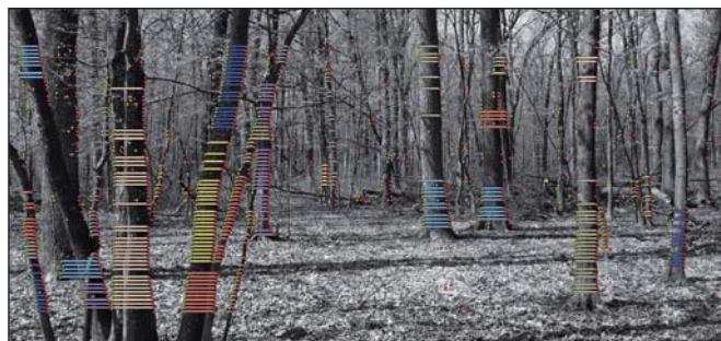
8. ábra. Közel fotogrammetria egyképes körlap meghatározáshoz
