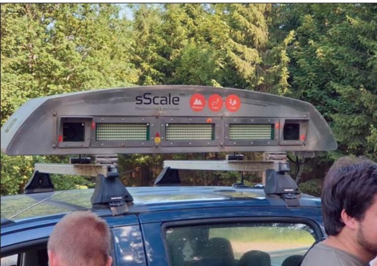
Faanyag felvételezésére használt eszköz (Fotó: Pálinkás Ákos)
