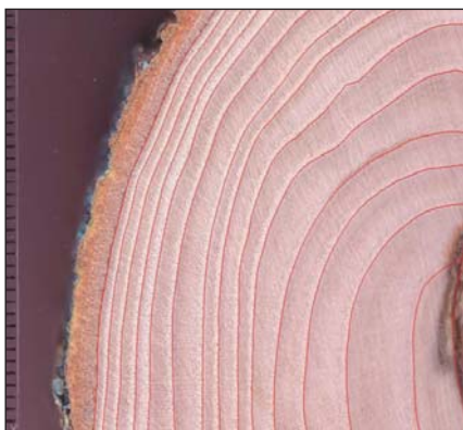
Digitalizálásra előkészített korong, az évgyűrűk „felülrajzolása”
