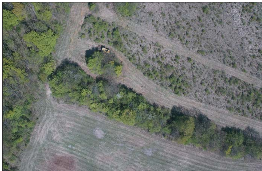
4. ábra. Ortofotón a kép közepén dolgozó szárzúzó gép körül pontosan mérhető a már elvégzett munka területe
