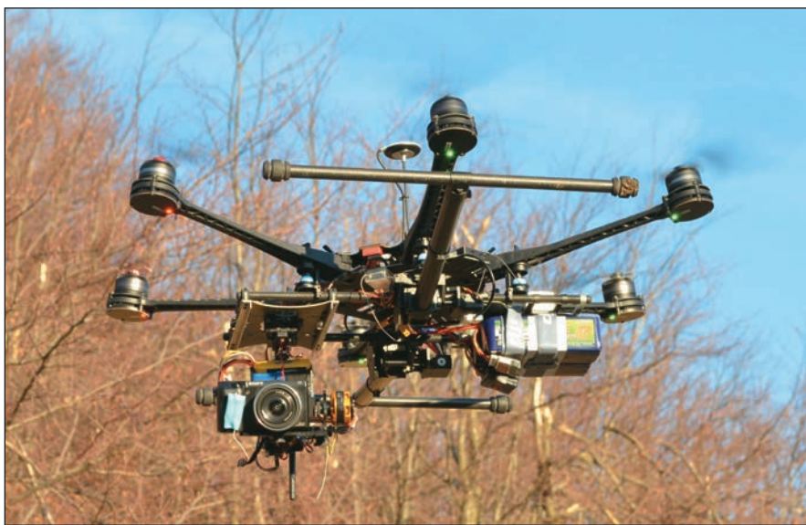
DJI S900 alapra épített kopter (Forrás: FBSC Kft.)
