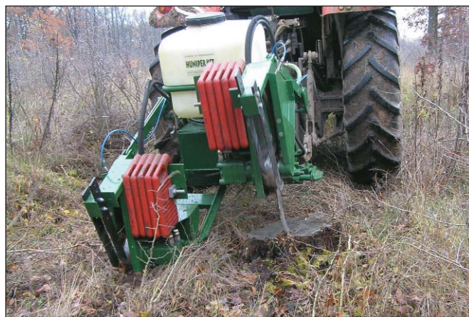
2. ábra. Az injektáló elem áthaladása a tuskón
