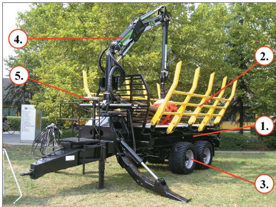
2. ábra. Az erdészetű többcélű kihordó fő szerkezeti részei: 1. vázszerkezet, 2. mozgórakoncás felépítmény, 3. futómű, 4. hidraulikus daru, 5. hidraulikus rendszer
