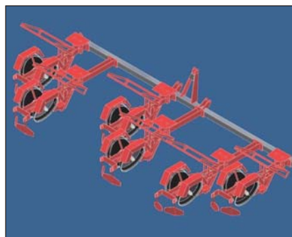
3. ábra. Három ikersorpárú, félautomatikus (fogóelemes) adagolószerkezetű, csúszócsoroszlyás dugványozógép 3D-s képe a tervezés végén
