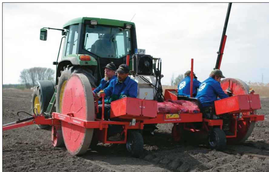
5. ábra. A BDÜ-2 típusú dugványozógép munka közben
