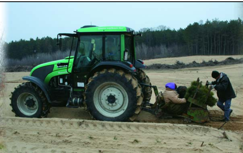
Fenyőcsemete-ültetés ERT EÜ-1 ültetőgéppel
