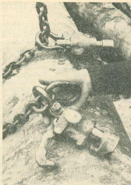
Az emelőlánc lecsatoló automatája
