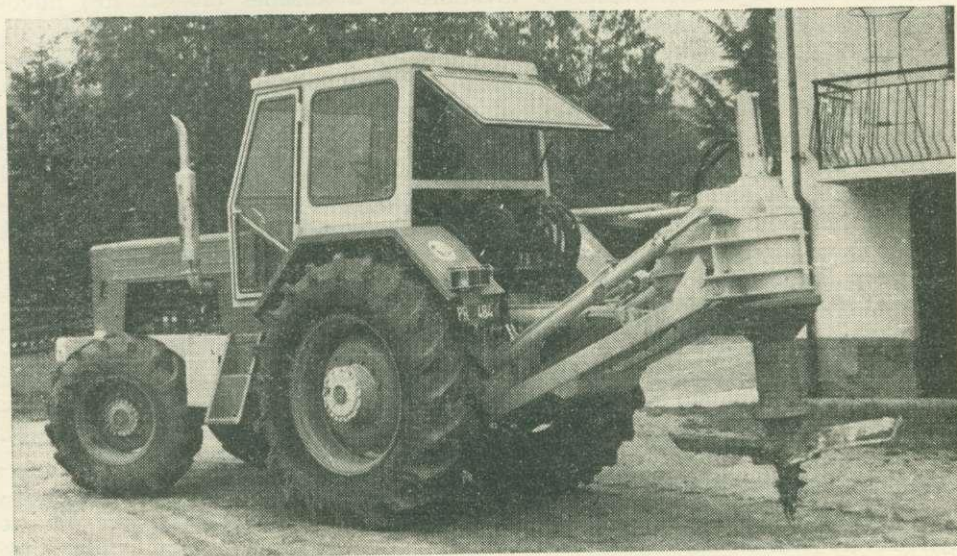
2. ábra. Az Ellettari cég nagy tuskó-forgácsolója, „ Elefante 200 DT ” típusú Ellettari — FIAT erőgépre szerelve
