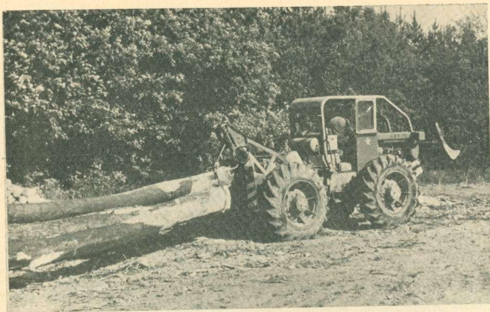
1. ábra. LKT—75 csörlős vontatótraktor, hosszúfavonsolás közben
