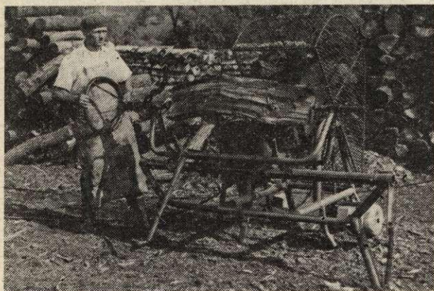
3. ábra. Egyszemélyes, egri gumikalapácsos kérgezőgép
