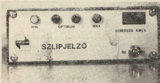
1. ábra. A szlipjelző készülék
