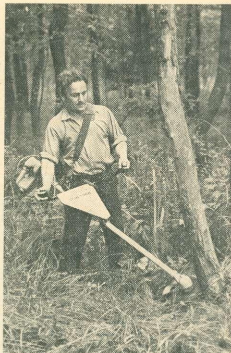
5. ábra. STIHL FS 08 tisztítóadapter munkában
