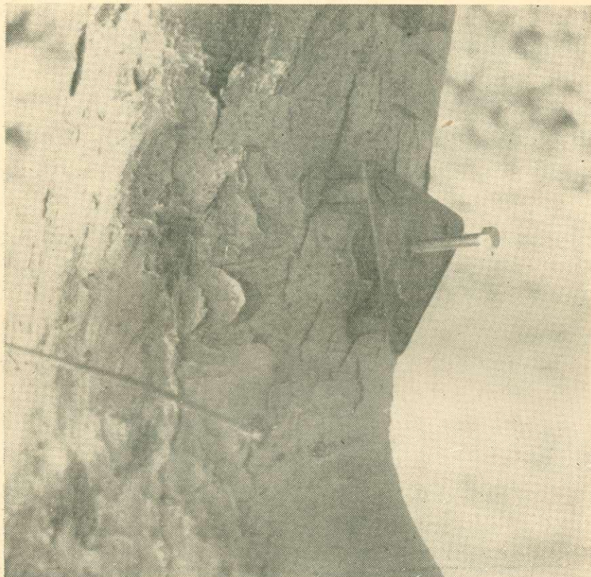
2. ábra. Dendrométer forgatótárcsa nélkül. A fa lassan benőtte a dendrométer lábait, míg a rézlemez folyamatosan közelebb „nőtt” hozzá.
