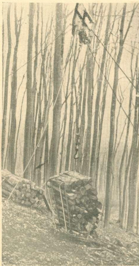
6. ábra. Teher felhúzása a futómacskához leterhelő hely előtt
