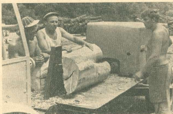
3. ábra: TH—01 hasítógép munkában
