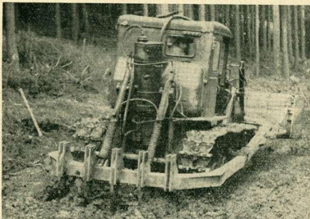
1. ábra. A DT—54A traktor-ra adaptált talajszaggató munkában a vizsgálati szakaszon. A szaggató a Kertészeti Kutatóintézet CSSZSZK konstrukciója.
