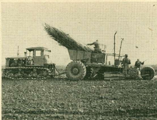
4. ábra. T—74 traktorral vontatott SzKSz—1 suhángültető gép
