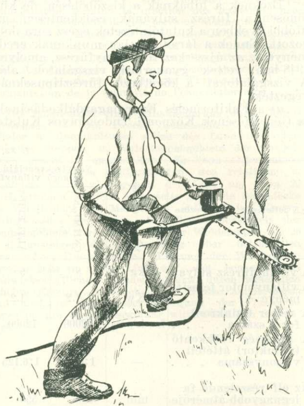
3. sz. ábra. CNIIME K-5 fűrész munkaközben Рис. 3. Моторист подпиливает дерево пилой ЦНИИМЭ К-5. Fig. 3. La scie CNIIME K 5 en travaillant
