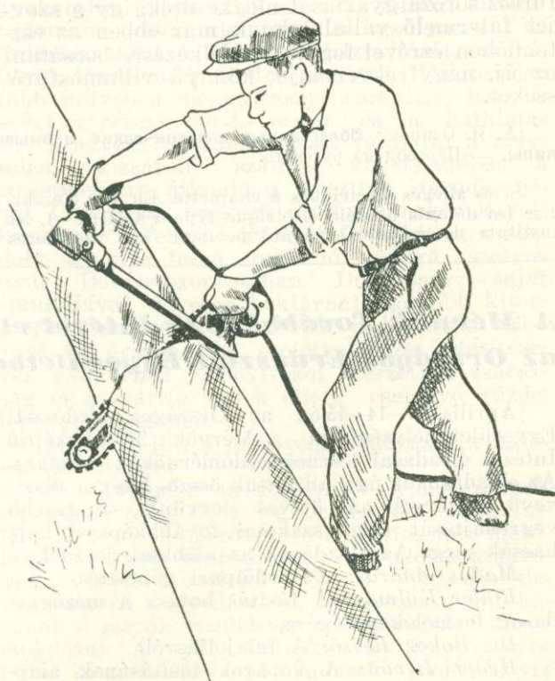
4. sz. ábra. Szálfák eldarabolása CNIIME K-5 villanyfűrészrel.
