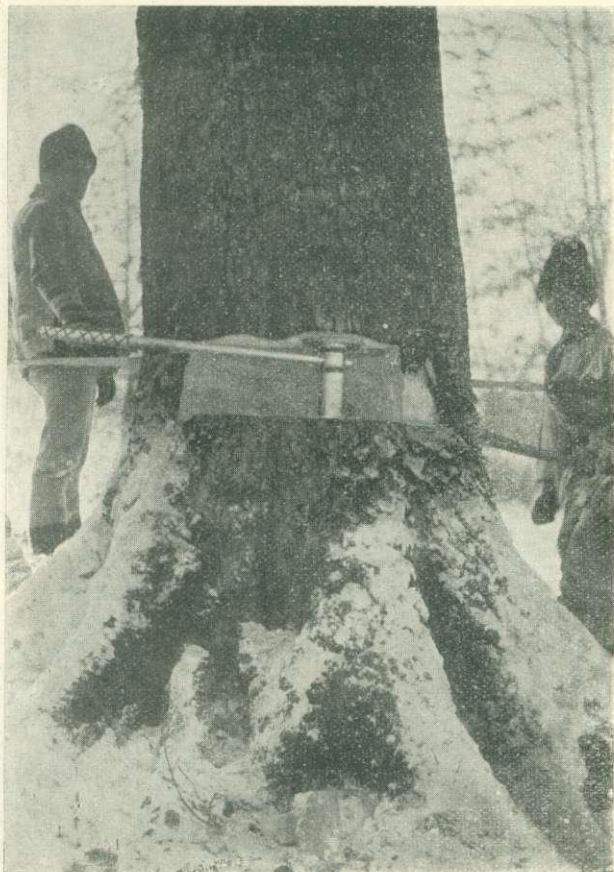
2. kép. Bartha-féle fadóntócsavar használatban. Kezdő helyzet.
