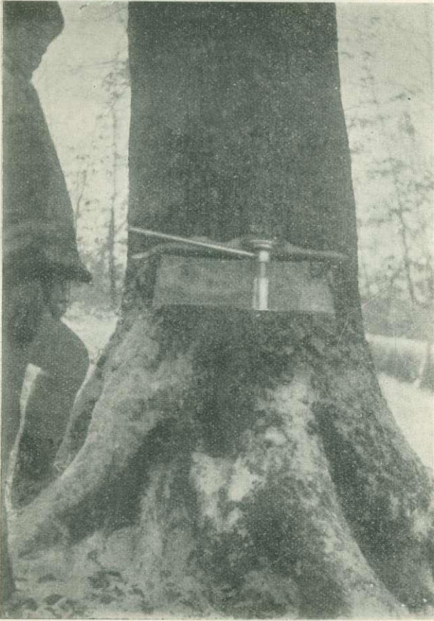
3. kép. Bartha-féle fadóntócsavar használatban. A dőlés pillanata. A csavar 48 mm-re van emelve.
