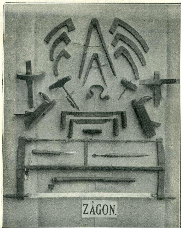
13. kép. Háziipari kádárszerszámok Háromszék megyéből. (Szóts Albert felvétele.) Fölül jobb- és balfelől dongamértékek, közbül körzők; középen jobbfelől csigafuró, balfelől állítós csapfuró. Ugyanabban a sorban bal- és jobbfelől a csinrovó, alattuk hántó- és takarítógyalu. Ezek között szivókések: alul 2 „egyenes“, fölül egy kis átmérőjű edényeknél használt „görbe kés“, amelyet még „horkoló“-nak is mondanak. A kámvás fűrész között találunk még vésőt, rásplyt és hosszunyelű kapocsbaltát. A kádár faragószékét és kecskegyaluját a 9. képen (304. oldalon) látjuk.
