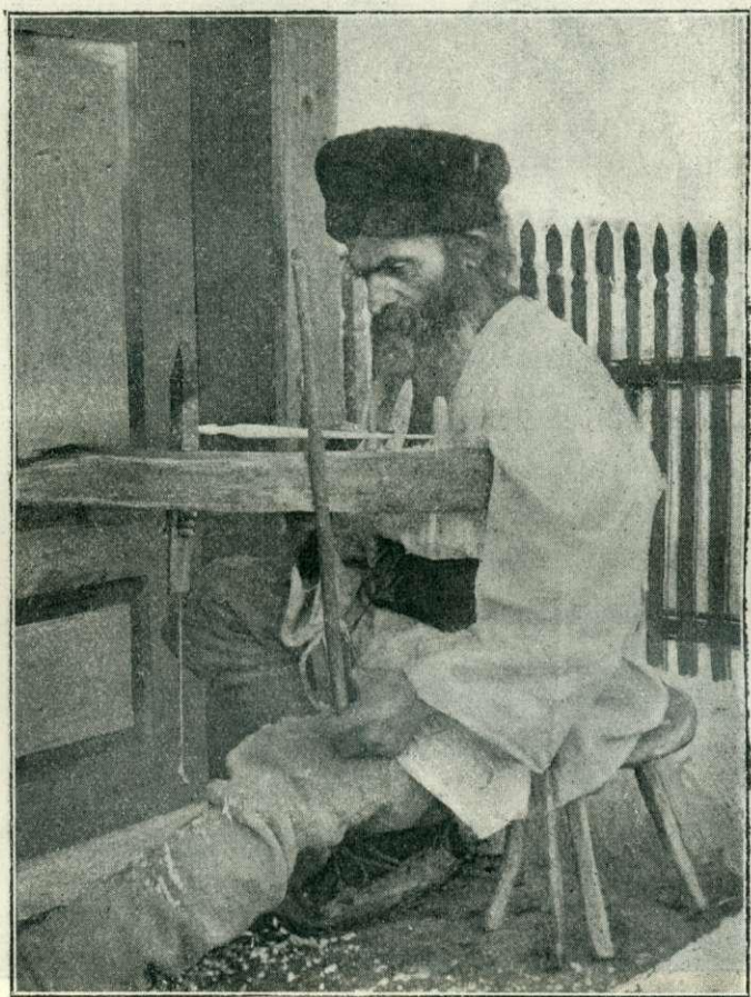
14. kép. Kezdetleges esztergapad nyirettyüs hajtással. Háromszék megyéből. (Szóts Albert fölvétele.)
