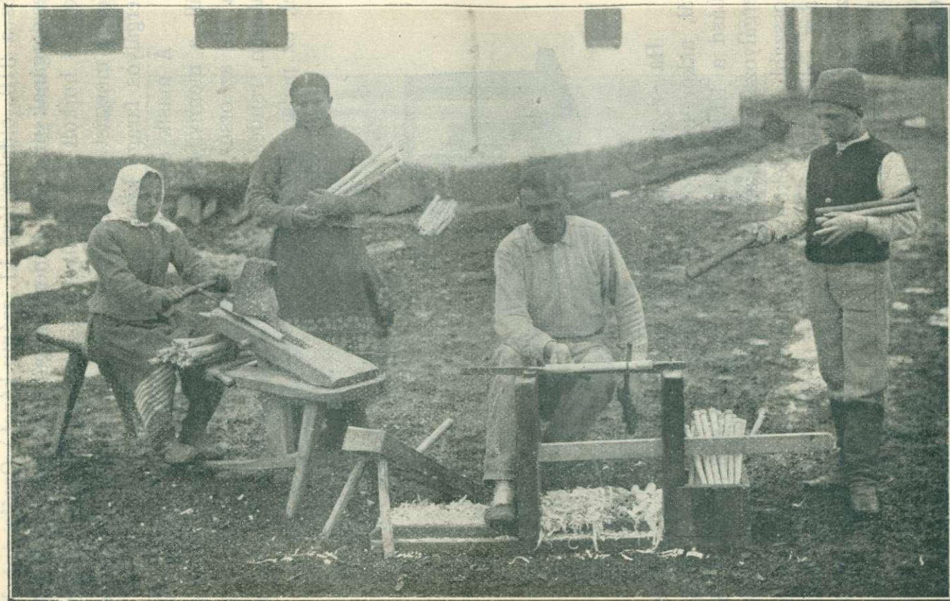
16. kép. Furulya-eszterga Sáros megyéből. Feltüntetve az esztergályozás és a hosszanti furás módja.
