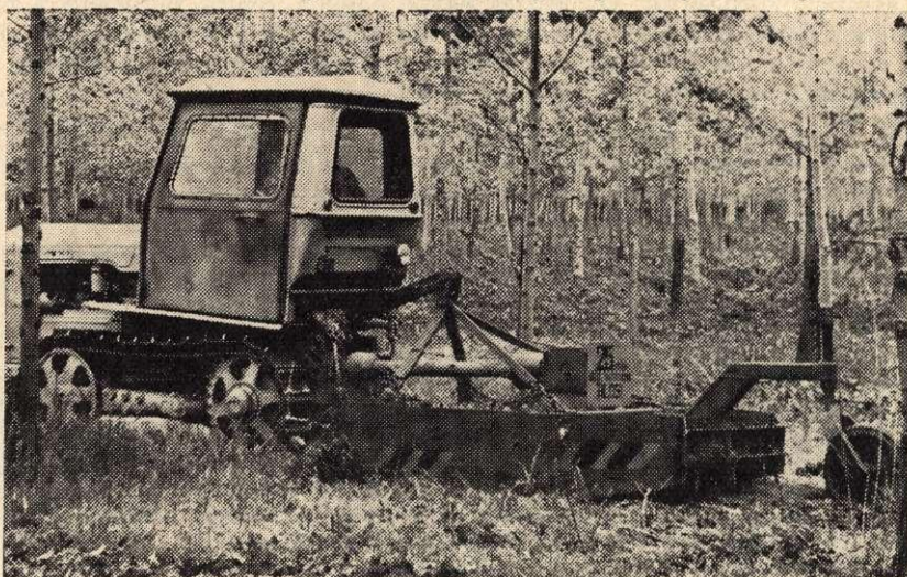
2. ábra. Az RZ—1,5 rotációs szárzúzót vontatja a TL—30A traktor
