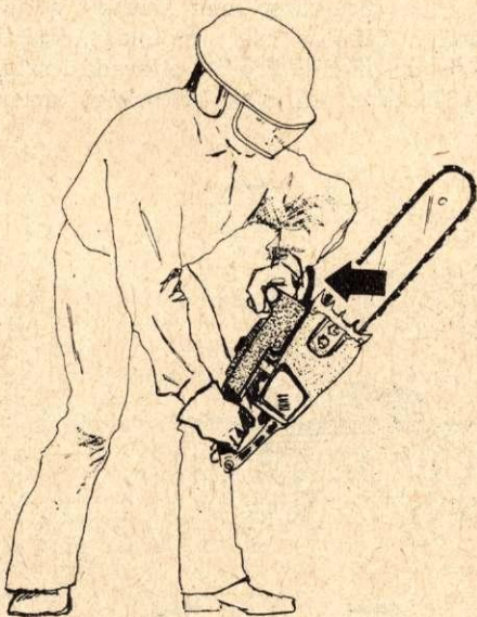
3. ábra. Csökkenti a baleseti lehetőséget az első fogantyú elé szerelt műanyag kézvédő is
