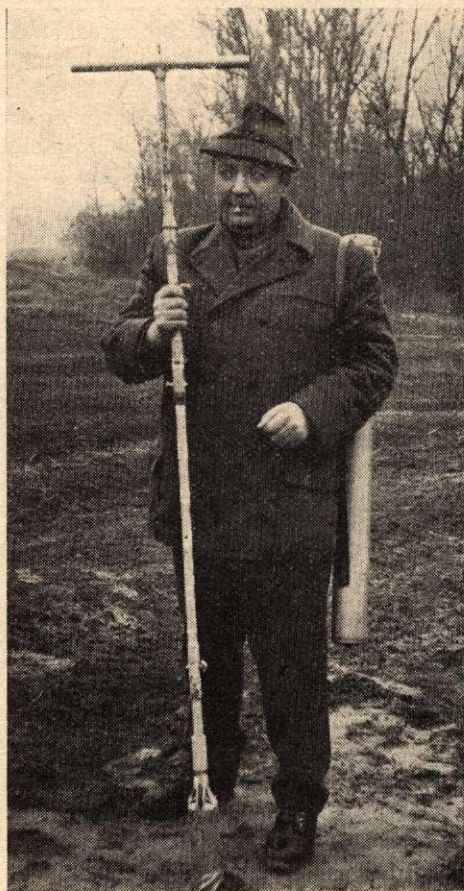
A munkára kész talajszonda és szállító tokja
