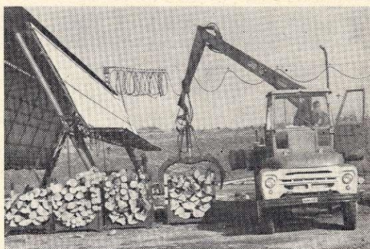
5. ábra: A nagyobb tönköket a daru helyezi a hasító-gépbe
