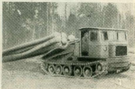
TDT. 54. új közelítő traktor rakodás előtt leeresztett rakodólemezzel és szálfaköteg vontatása közben
