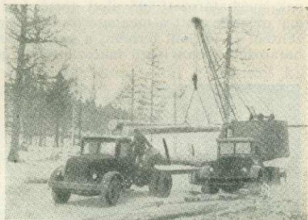
MAZ. 200. szálfaszállító gépkocsi rakottan és K—51. típusú autódaruval való rakodás közben
