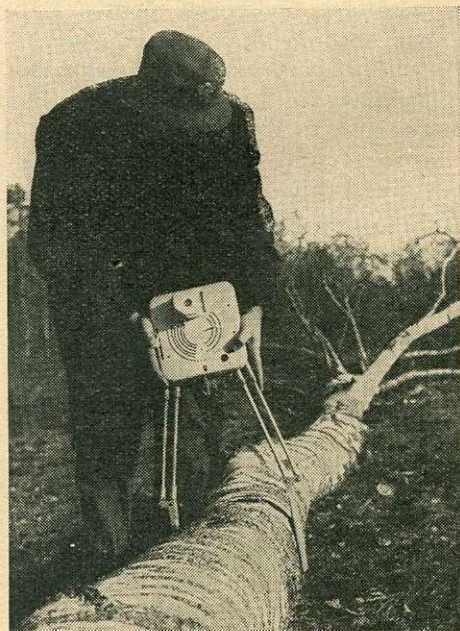
Kitermelt faanyag bemérése a Kyrítz-i átlalóval
