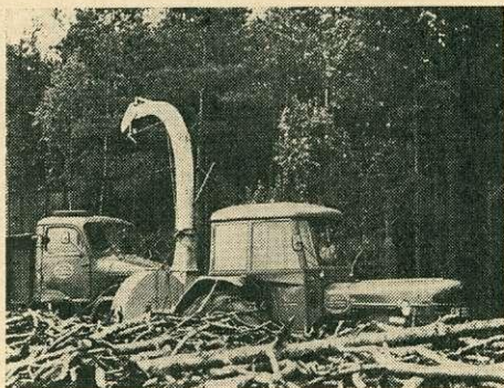
5. ábra: Lengyel gyártmányú DVPA—100-as típusú aprítógép (tárcsás típus; tárcsaátmérő 1000 m/m, a tárcsa fordulatszáma 800/perc, maximális aprítható favastagság 14 cm, meghajtás „Urus—4011 típusú 45 LE/35 kW erejű traktorról), véghasználatból származó fa aprításában
