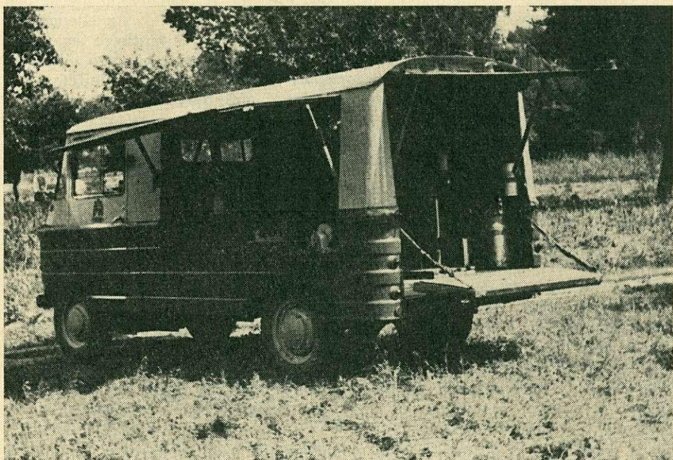
IV. A koncentrált vágástéri munkahelyekre a munkásokat külön célra szerkesztett és kézi műhellyel ellátott gépkocsikkal szállítják
