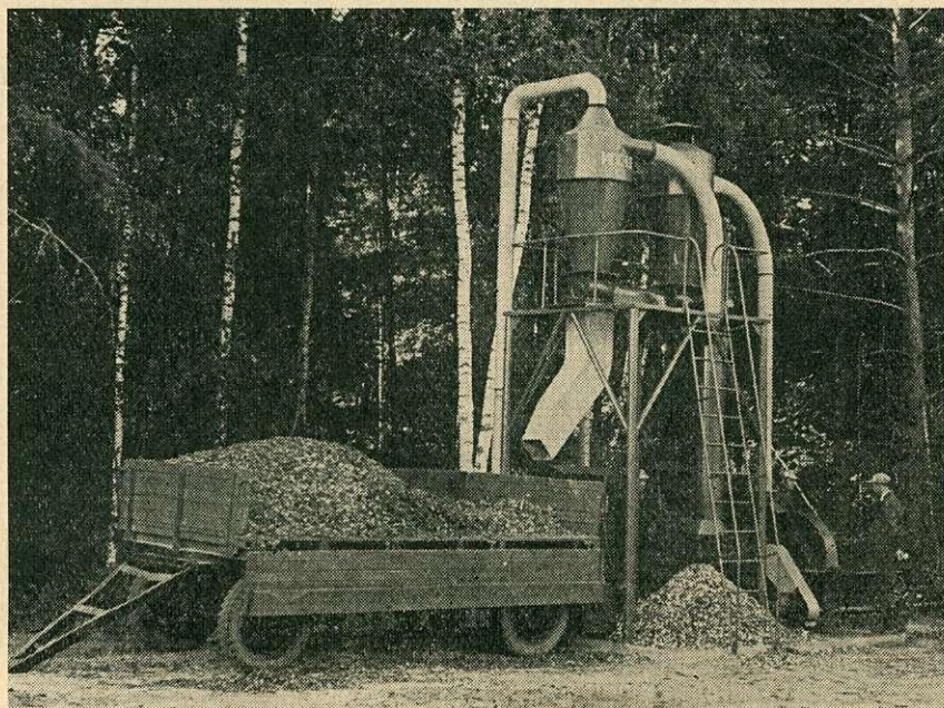
16. ábra: Leveles gallyak aprítására és pneumatikus osztályozására szolgáló IPSZ—1 berendezés
