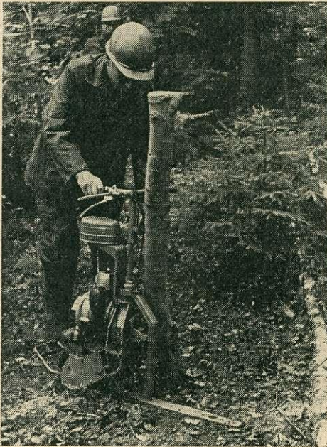
9. ábra: SZMA—1 önjáró Druzsba motorfűrész
