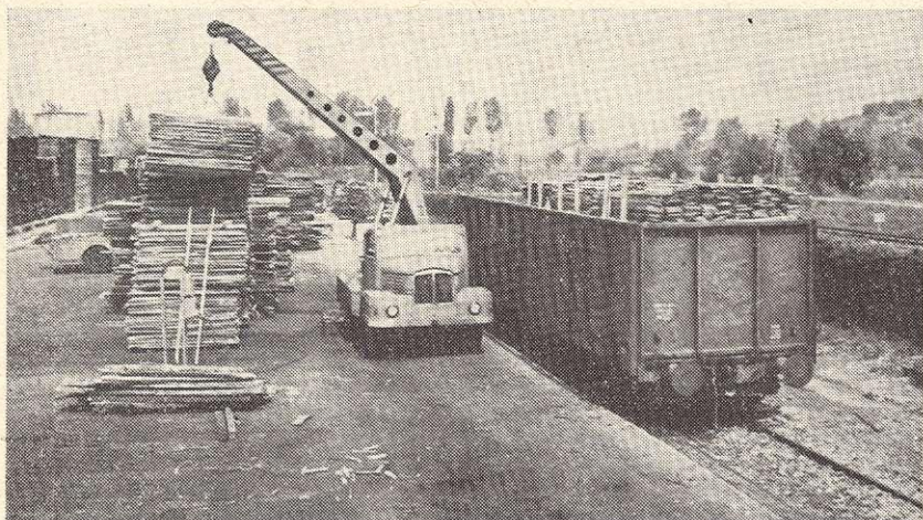
3. ábra. Egységgratok vagonba rakása „Panther” autódaruval
