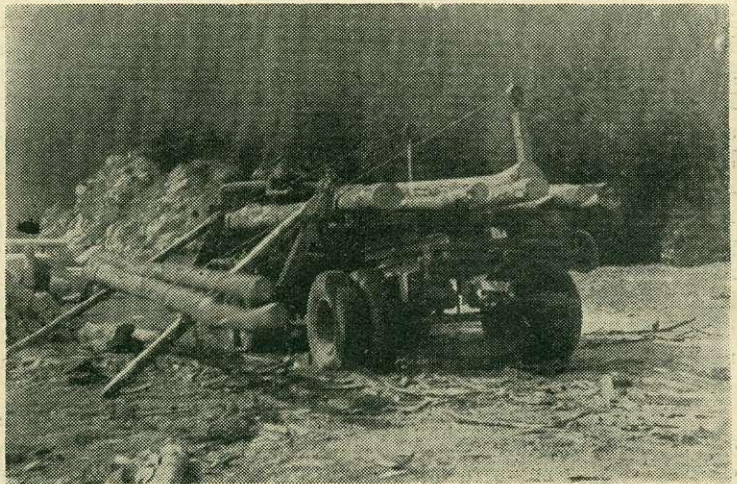
4. ábra. A hosszúfa rakodása kétdobos csörlő segítségével
