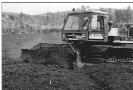
2. kép. Mangános agyagtermelés speciális dózerrel (Fotó: Horváth S.)
