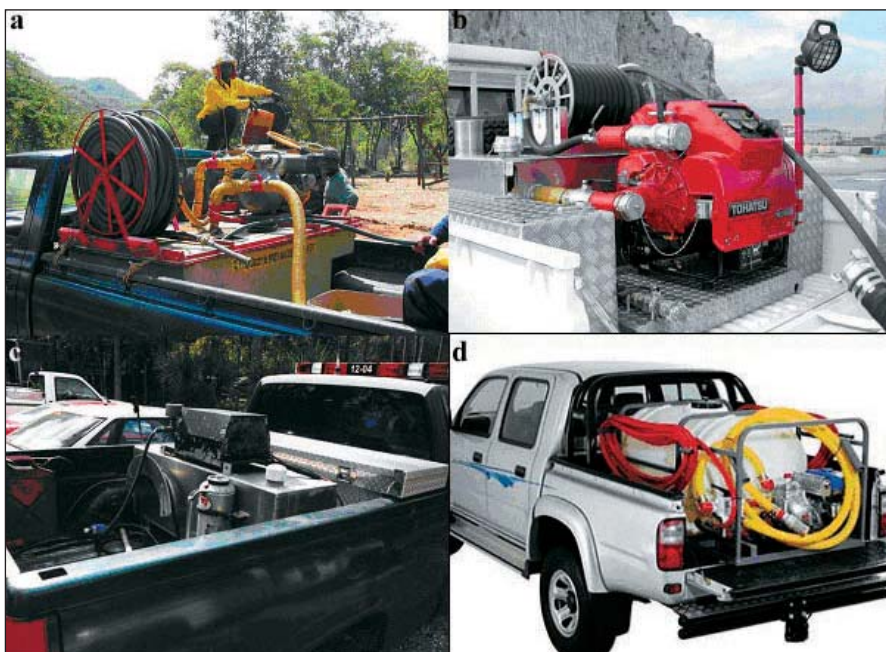
2. kép. Különböző teljesítményű és áru slip on unitok 2/a az olcsóbb de kitűnően használható afrikai kivitel 2/b a profi változat 800 literes tartállyal nagy teljesítményű szivattyúval 2/c a 300 literes tartállyal szerelt elektromotoros változat 2/d egy könnyen szerelhető zambiai változat 1000 literes tartállyal, Mitsubishi L200-on
