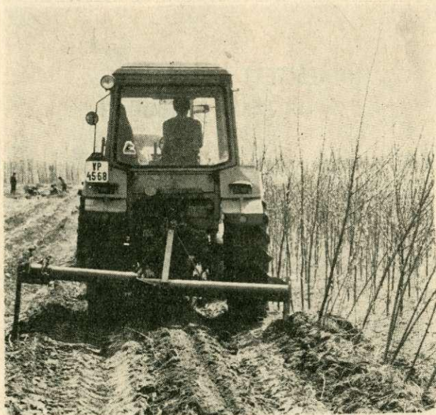
1. ábra. Iskolázott akác- csemete kiemelése a su- hángkiemelővel
