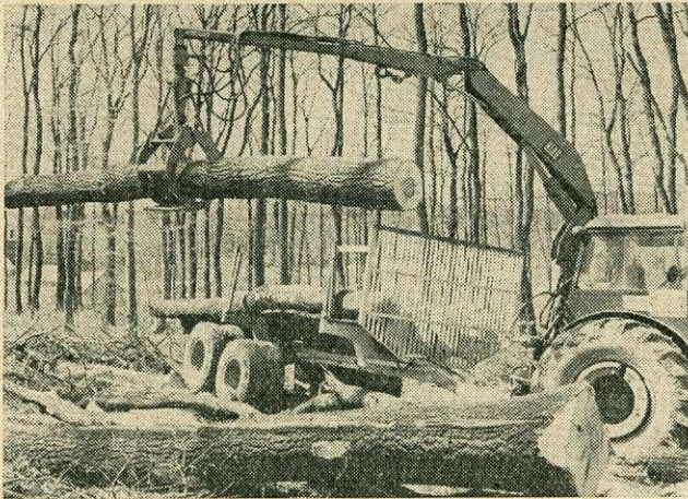
3. ábra. HIAB—173. tip. önrakodó daru D4K B traktorra szerelve, 12 t teherbírású egytengelyes pótkocsival
